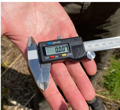
Wenn der Stammdurchmesser deines Baumes mehr als 100 mm beträgt, ist der Baum groß genug, dass du eine zweite Messung in der Höhe von 130 cm durchführen kannst. Nutze auch hierfür wieder den markierten Holzstock oder einen Zollstock. Sobald du den Messpunkt festgelegt hast, misst du erneut den Durchmesser des Stammes in mm, und notierst den Wert.
